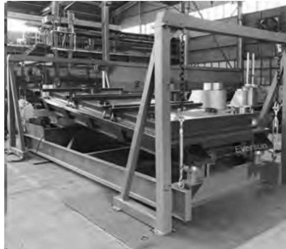
Гіраційний віброгрохот: закрита та відкрита конструкції
