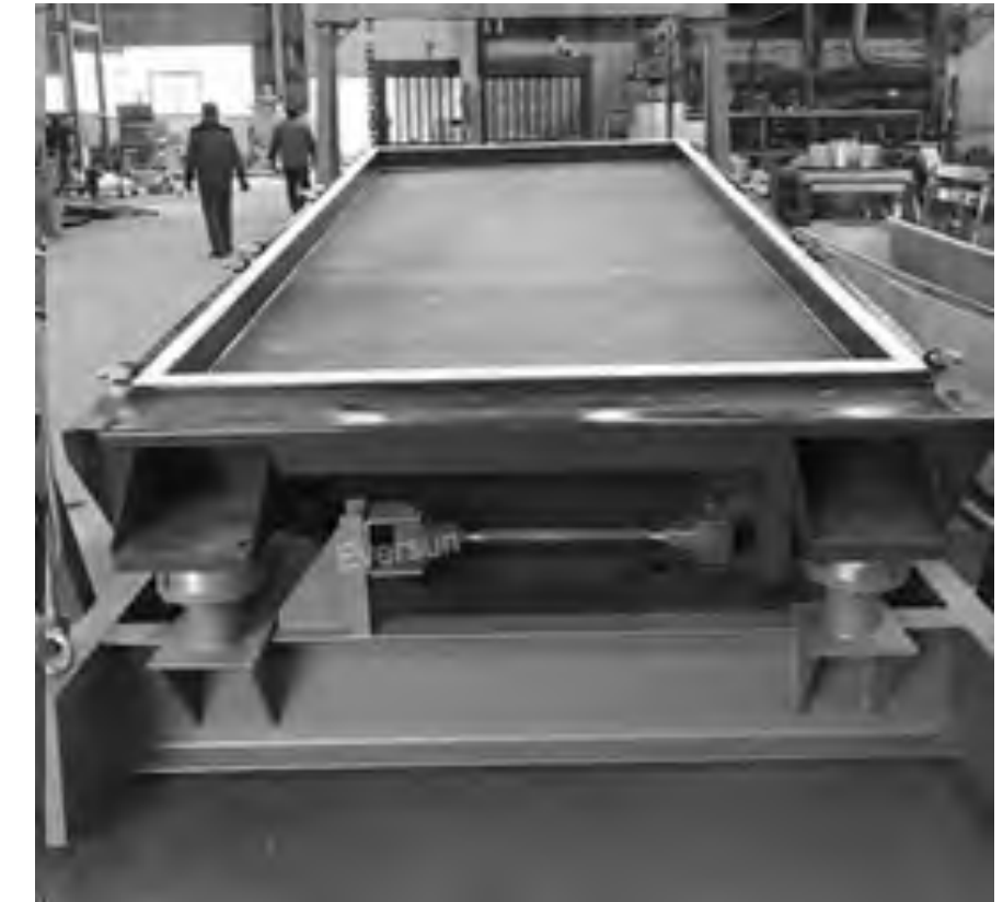
Гіраційний віброгрохот: закрита та відкрита конструкції
