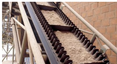
Рисунок 1.13 – Стрічковий конвеєр із стрічкою з бортами та поперечками
