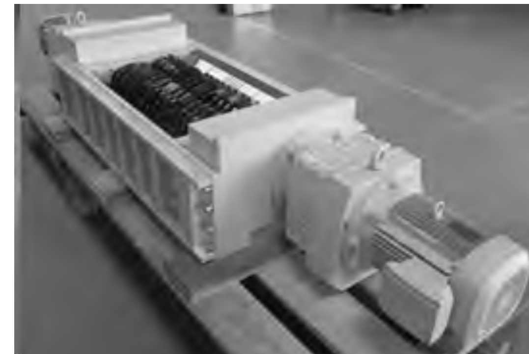
Двоболкові подрібнювачі металевих відходів серії ZW: а) ZW800; б) ZW300
