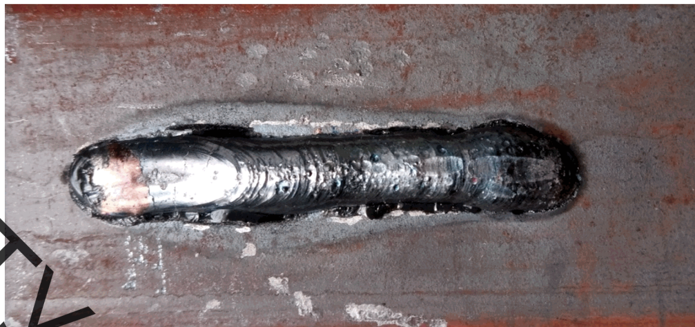
Рисунок 2.9 – Зразок №2, наплавлений з шаром графіту товщиною – 1мм
