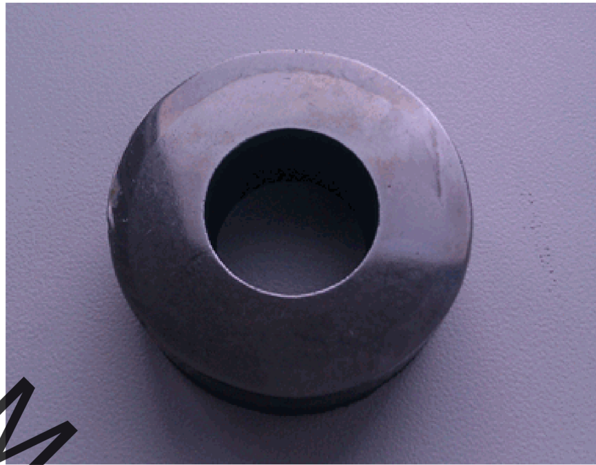
Рисунок 2.1 – Макрошліф сталевого круглого зразка після плазмового напилювання
