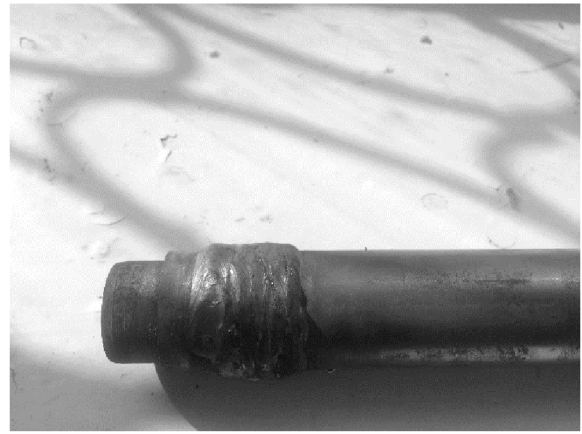
Рисунок.2.4 – Зразок до та після нанесення покриття
