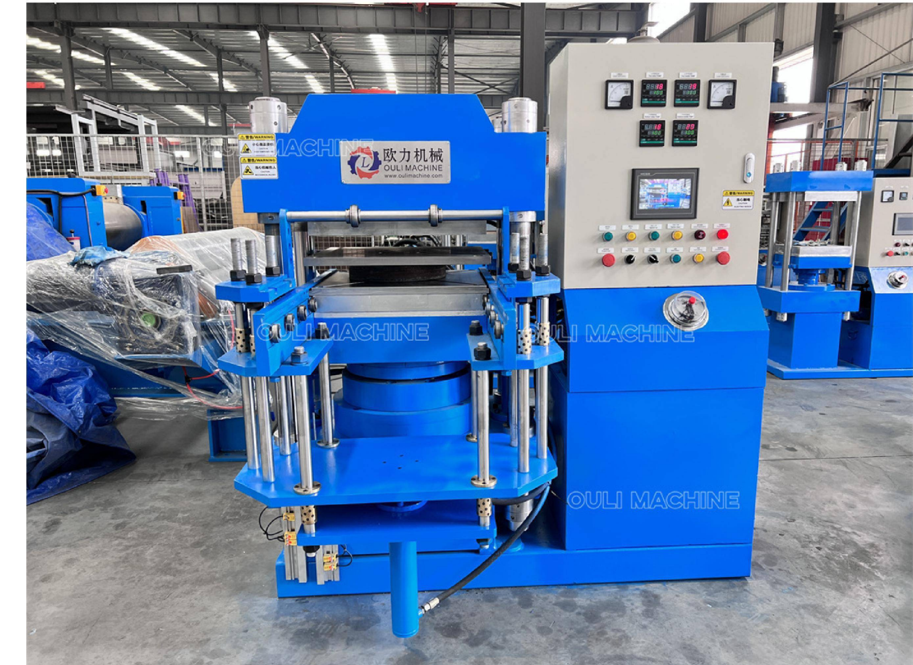
Рисунок 5 – Гідравлічний вулканізаційний прес MITSUBISHI PLC CONTROL, (Японія)
