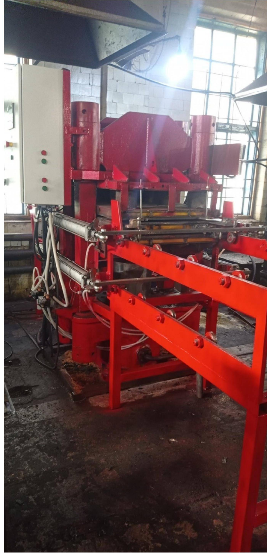
Рисунок 1 – Прес вулканізаційний гідравлічний ГМЗ-300-1300×2000 2Е виробник ТОВ «Гайсинський машинобудівний завод»
