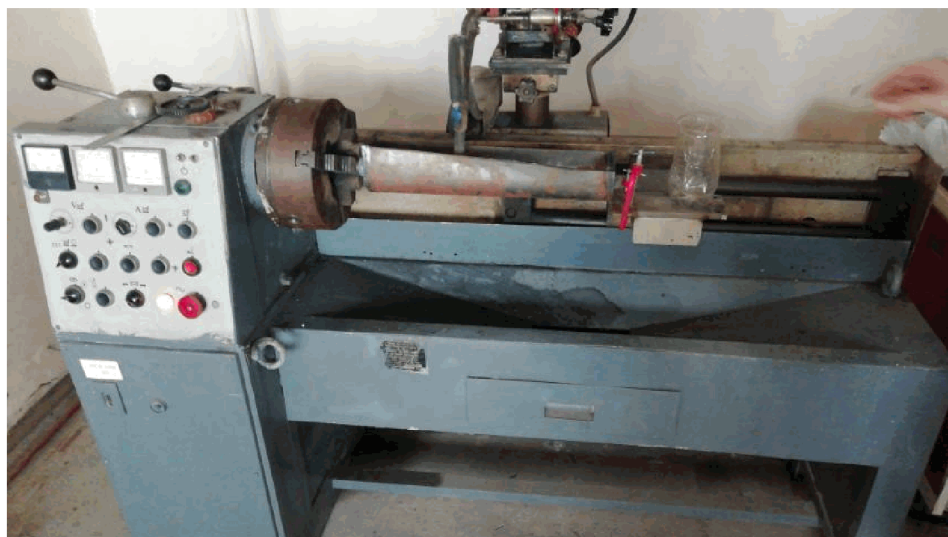
Рисунок 2.4 – Установка для наплавлення з водним охолодженням
