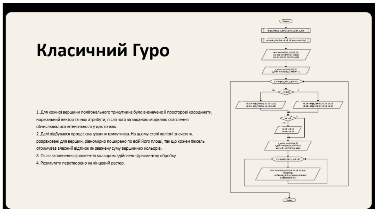
Рисунок Г.12 – Блок-схема зафарбовування класичним методом Гуро
