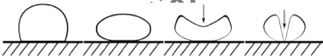
Рисунок 1.5 – Схема змикання кавітаційних бульбашок на поверхні
