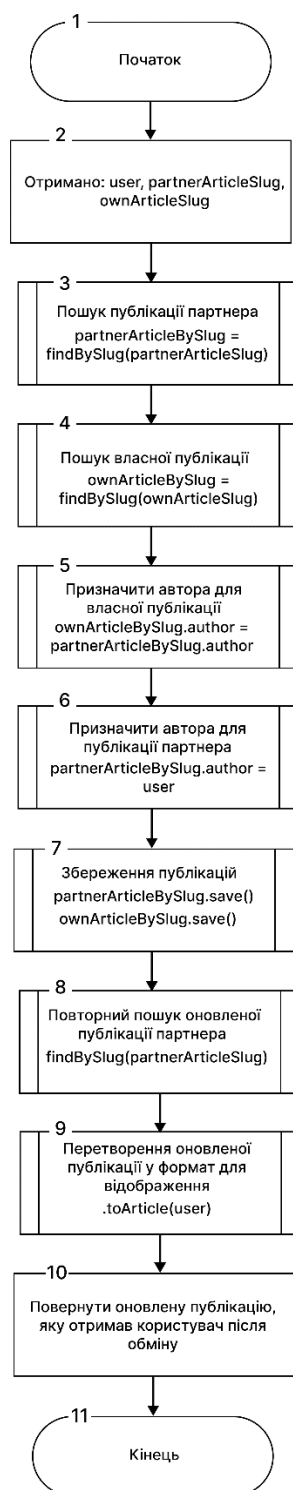
Рисунок 3.6 – Блок-схема алгоритму обміну публікаціями між користувачами
