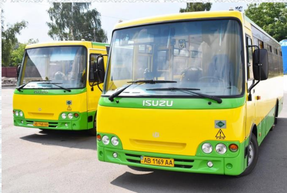
Рисунок 1.4 – Автобуси АТАМАН (ISUZU) A092G6, що працюють на газовому паливі
