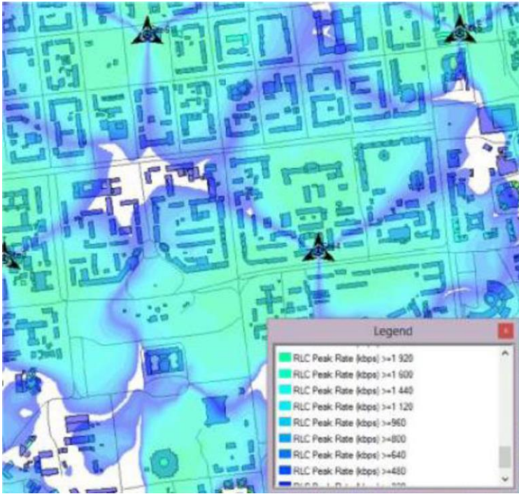
Рисунок 4.5 – Результат моделювання покриття технологією HSDPA
