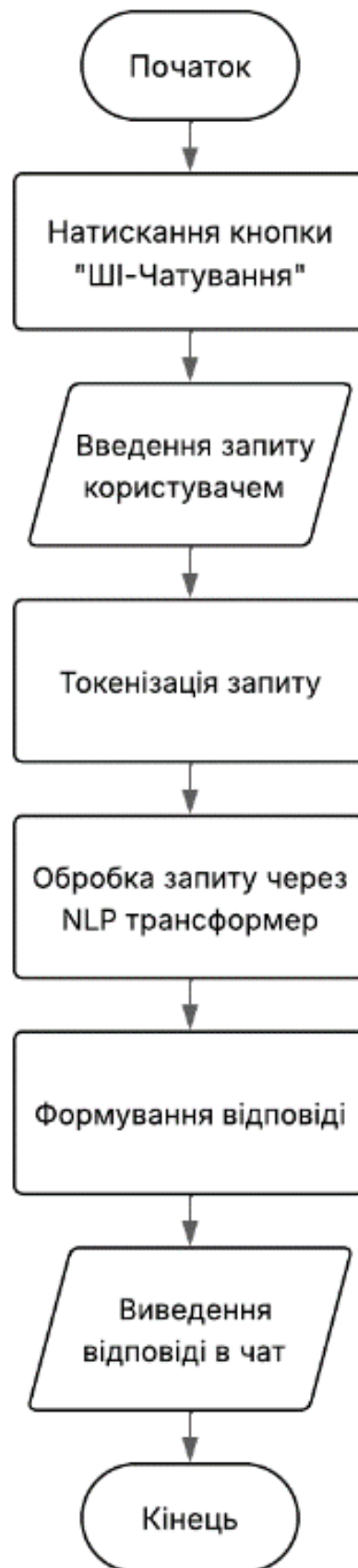
Рисунок 3.10 – Блок-схема алгоритму роботи інтелектуального чат-асистента
