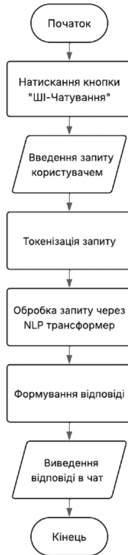
Рисунок 3.10 – Блок-схема алгоритму роботи інтелектуального чат-асистента
