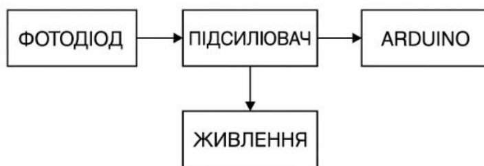
Рисунок 3.2 – Функціональна схема приймача
