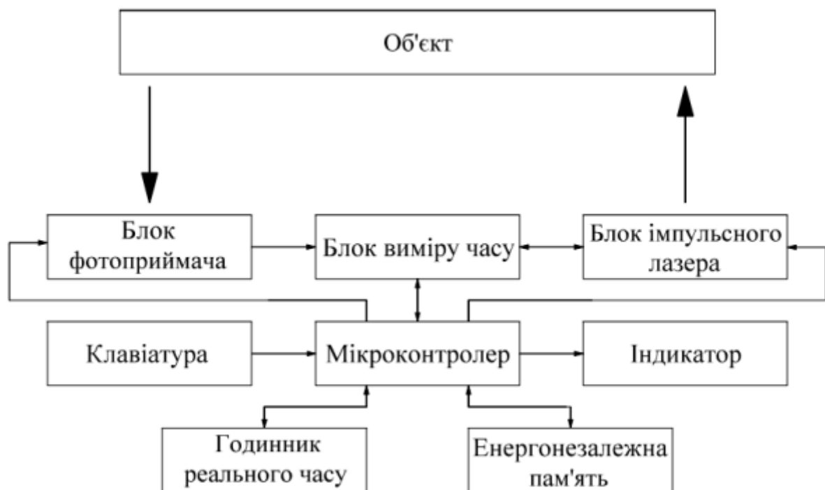
Рисунок 3.1 – Узагальнена схема лазерного далекоміра
