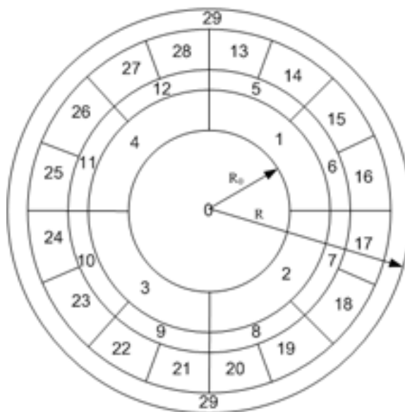
Рисунок 3.6 – Схема сегментації плямоподібного зображення профілю лазерного променя
