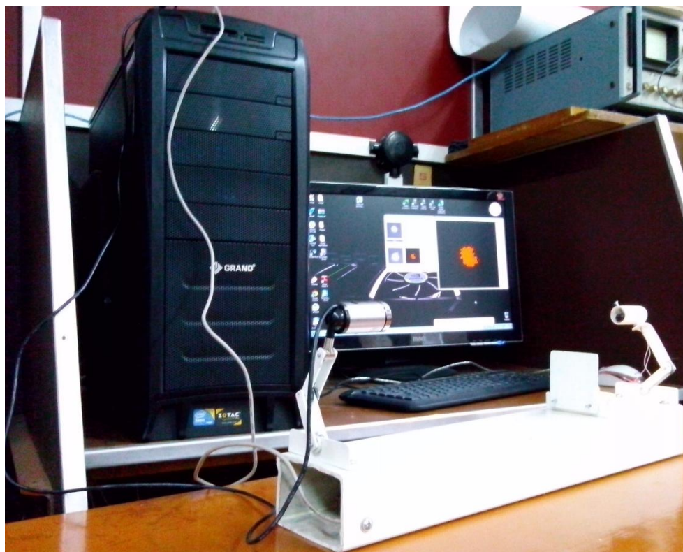
Рисунок 3.5 – Апаратний макет інформаційно-вимірювальної системи для оброблення профілю лазерного променя з класифікацією прямоподібних зображень
