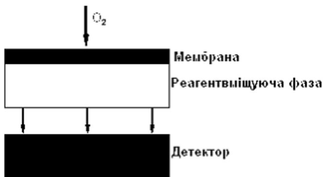
Рисунок 3.9 - Схема роботи необоротного волоконно-оптичного сенсора на кисень.
