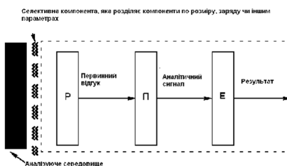
Рисунок 3.8 - Схема роботи хімічного сенсора: Р - хімічно чуттєвий шар, П - перетворювач сигналу, Е - електронний блок.
