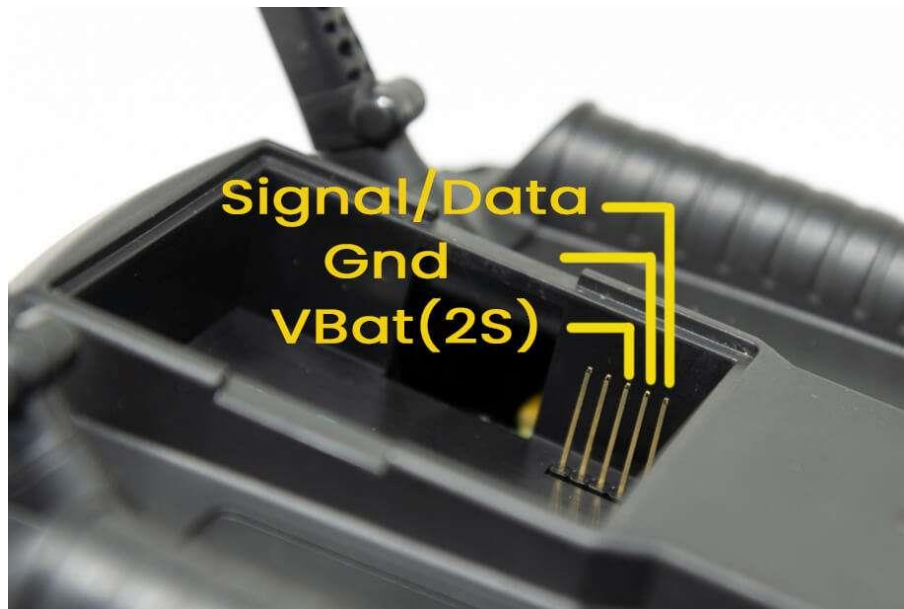
Рисунок 2.7 – Розпіновка модуля JR [11]
