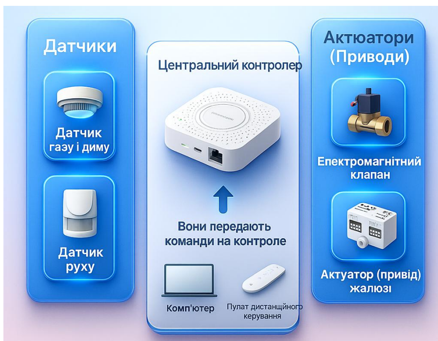
Рисунок 2.2 – Централізована архітектура домашньої автоматизації
