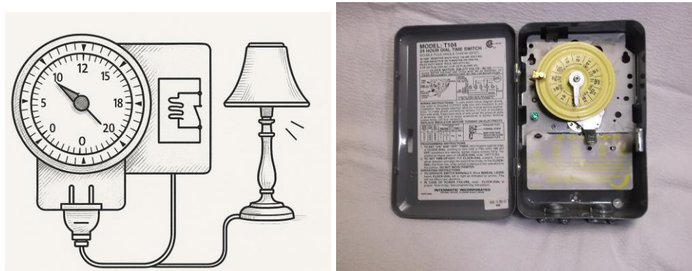
Рисунок 1.1 – Перший прототип пристрою автоматизації освітлення на базі електромеханічного таймера
