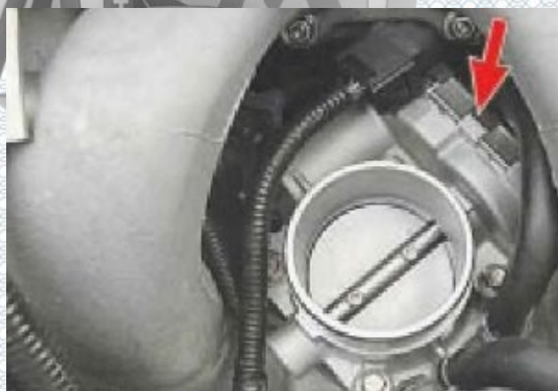
Рисунок 3.2 - Датчик положення дросельної заслінки
