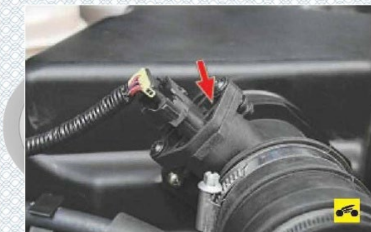
Рисунок 3.4 - Комбінований датчик масової витрати і температури повітря
