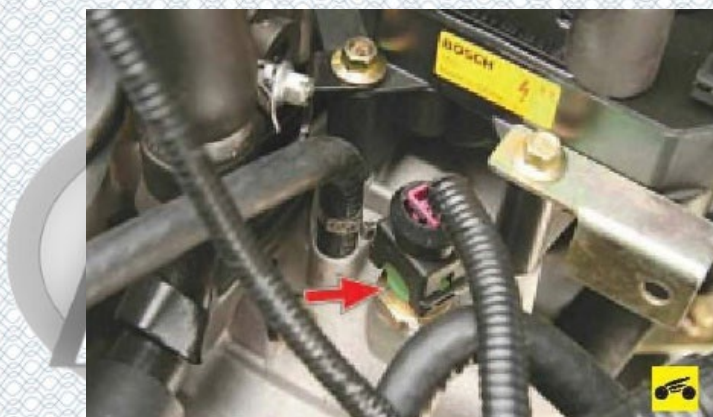
Рисунок 3.3 - Датчик температури охолоджуючої рідини
