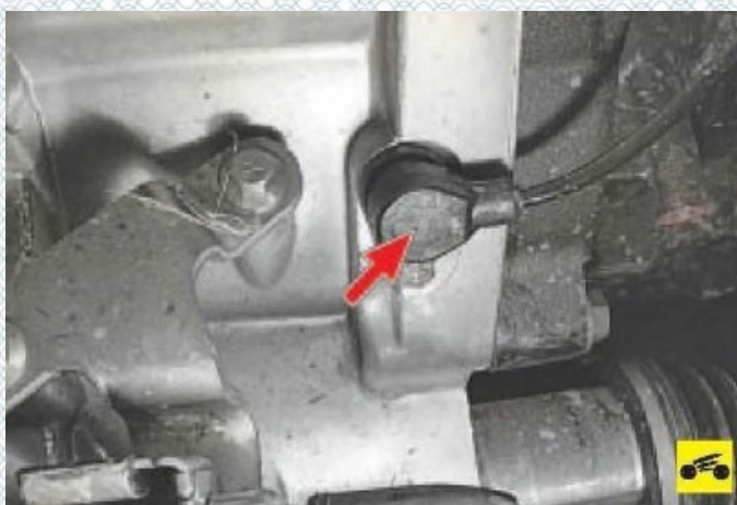
Рисунок 3.1 - Датчик положення колінчастого валу
