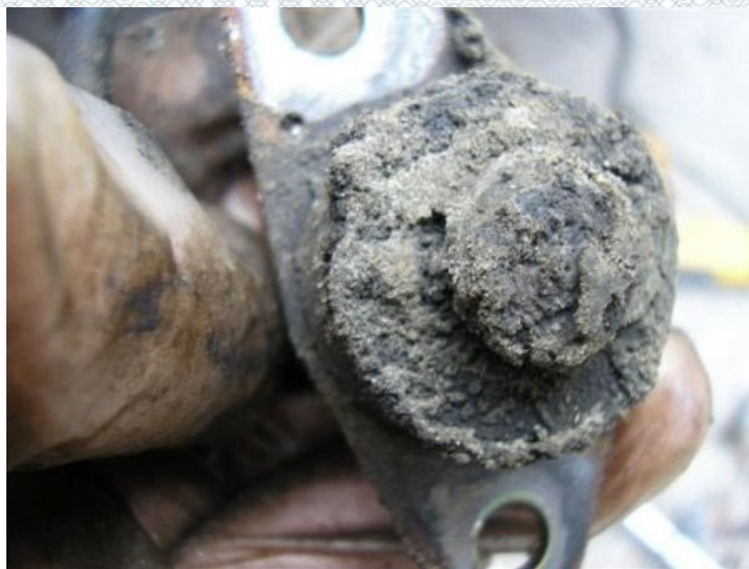
Рисунок 1.9 - Забруднення датчика ABS
