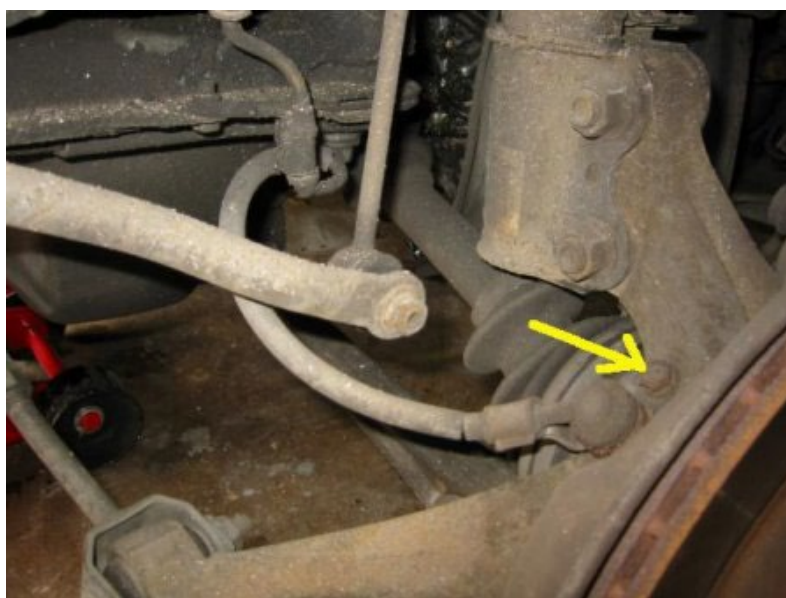
Рисунок 1.8 – Розташування датчика системи ABS
