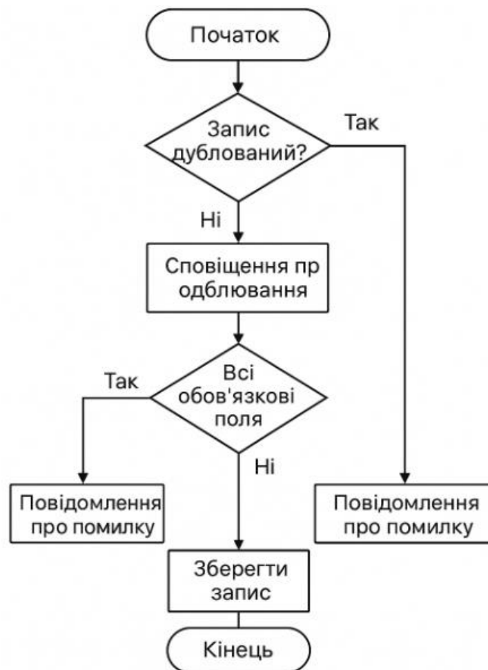
Рисунок 2.5 – Схема ілюструє логіку перевірки запису перед збереженням у системі «Помічник рієлтора».
