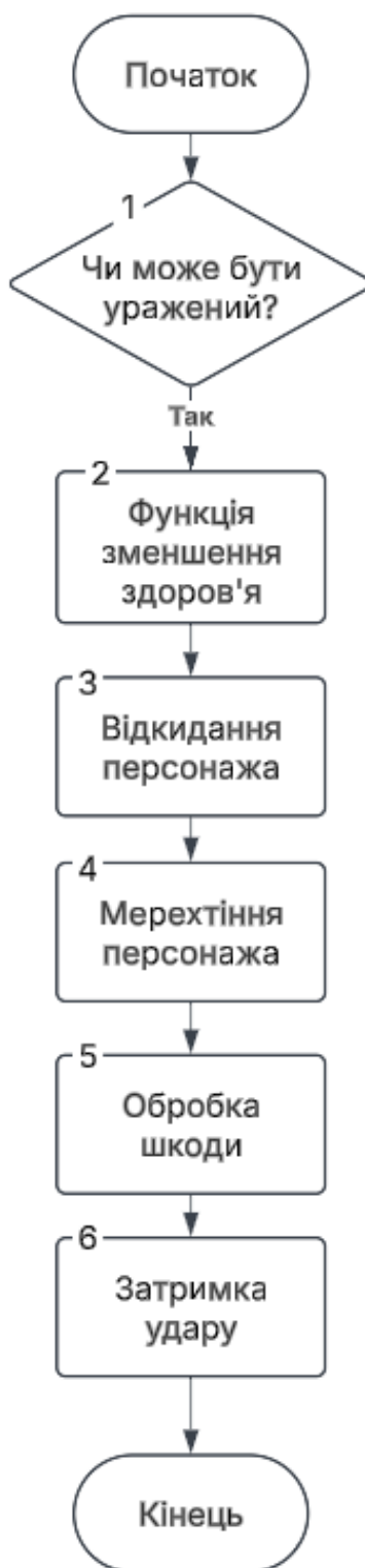
Рисунок 2.7 – Схема алгоритму події отримання будь-якої шкоди
