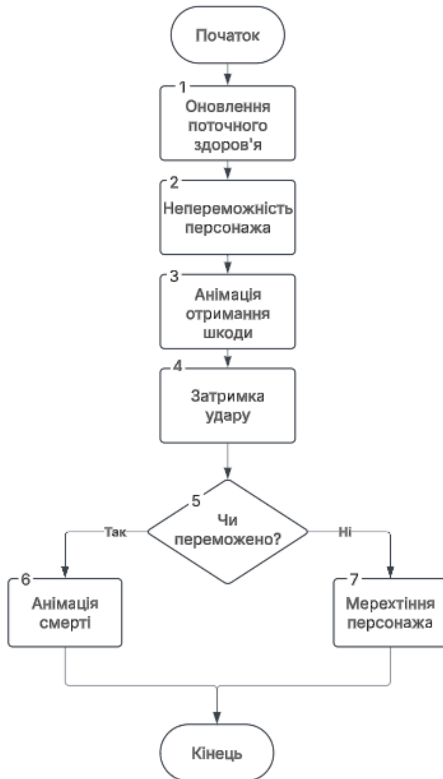
Рисунок 2.8 – Схема алгоритму роботи функції обробки шкоди для головного героя
