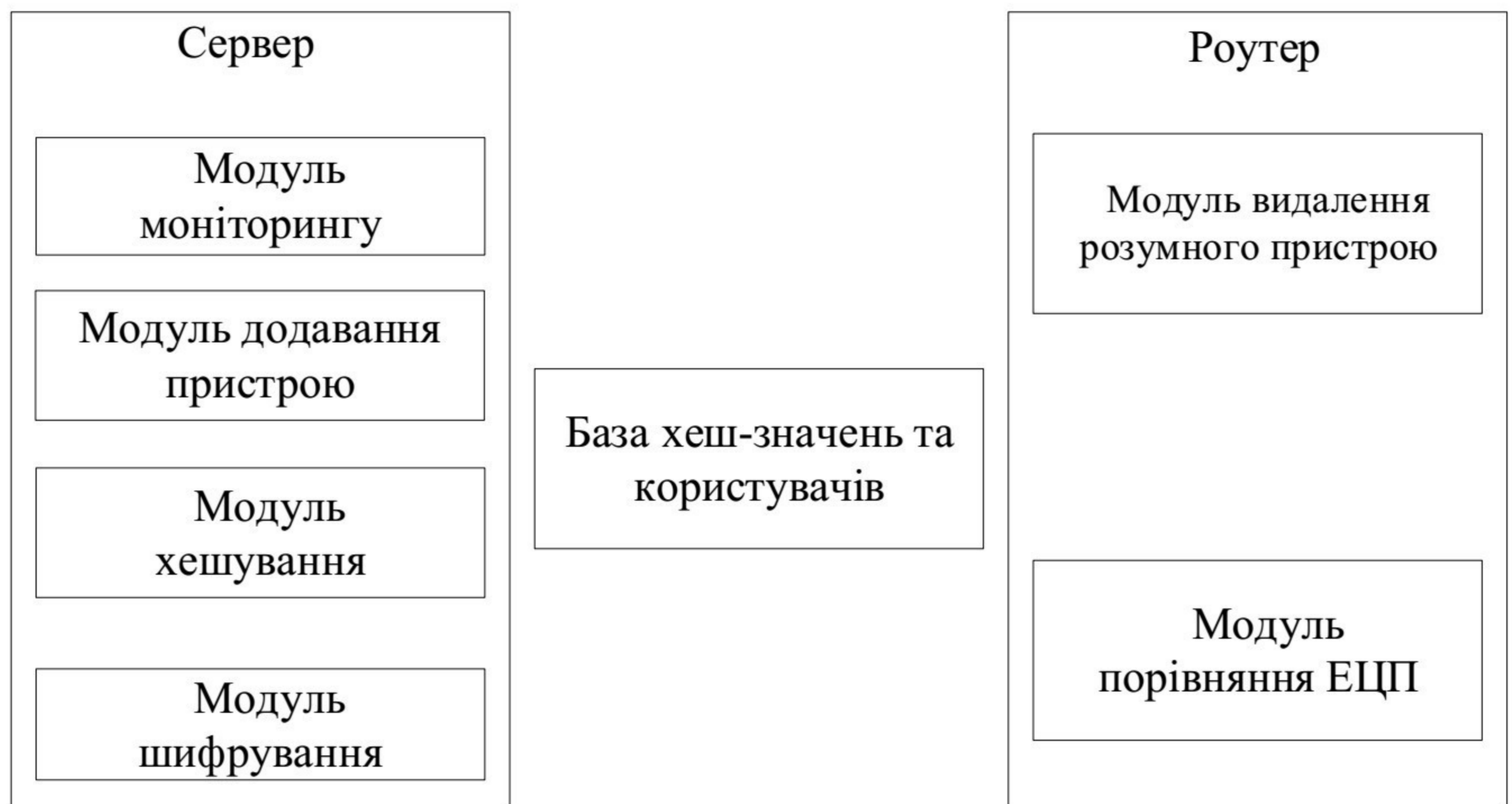
Рисунок 3.2 – Складові на стороні серверу та роутеру.
