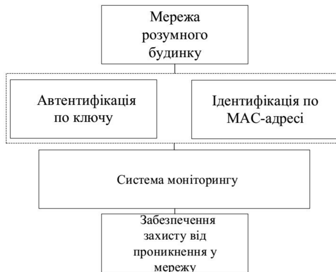
Рисунок 2.2 – Складові розроблюваної системи моніторингу
