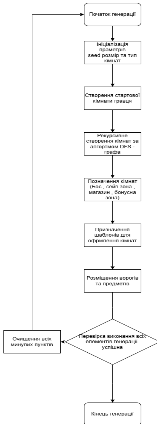
Рисунок 2.3 – Блок схема генерації рівнів
