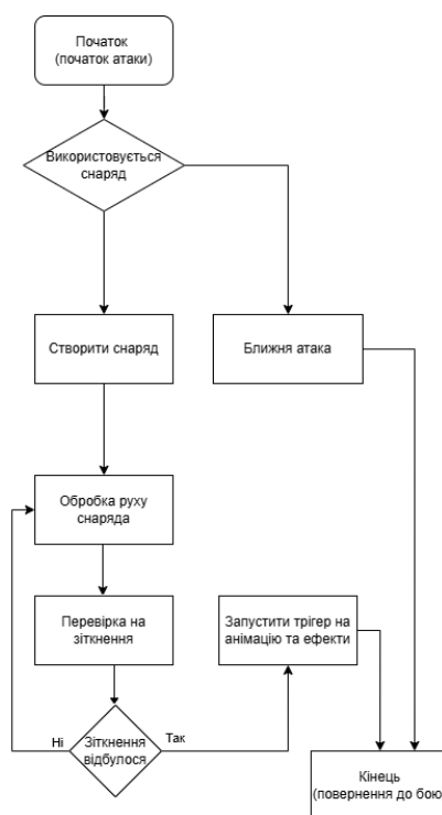
Рисунок Г.5 – Блок схема взаємодії Projectile System
