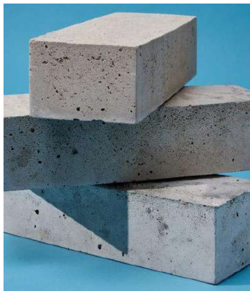
Рисунок 2.4 – Блоки «зеленого» бетону
