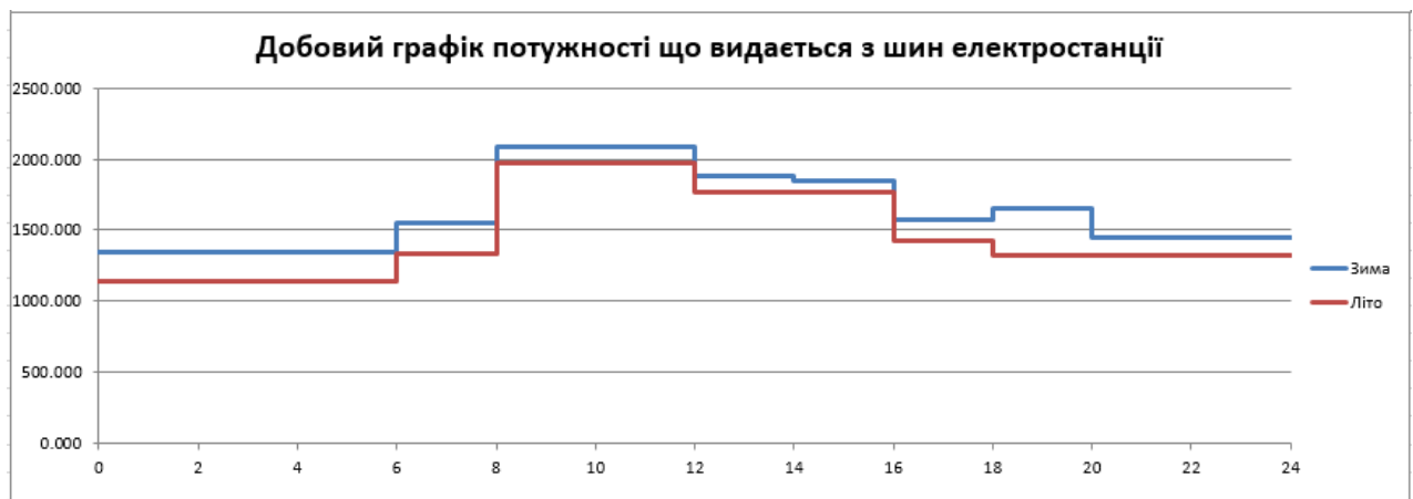
Рисунок 1.3 – Графік сумарної потужності, що віддається з шин станції
