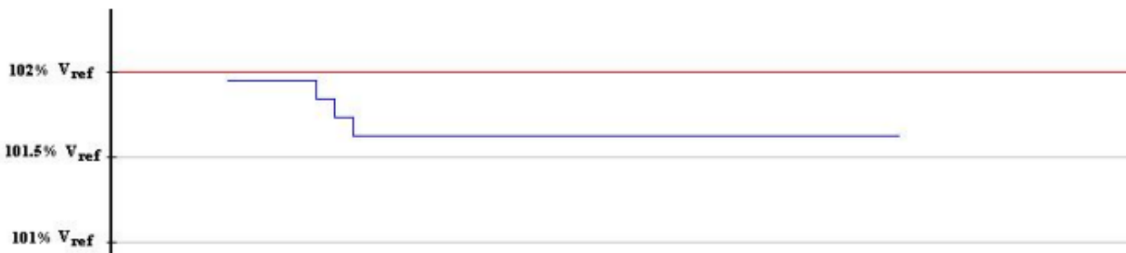
Рисунок Б11 – Небажані перемикання, коли початковий рівень напруги лише трохи нижчий за верхню межу діапазону регулювання.
