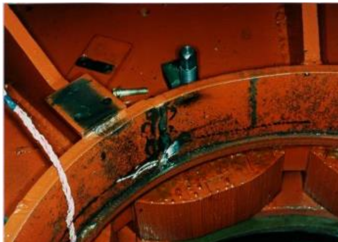
Рисунок 1.6 – Перегрів внаслідок замкнень електромагнітного екрану на пресуючу плиту
