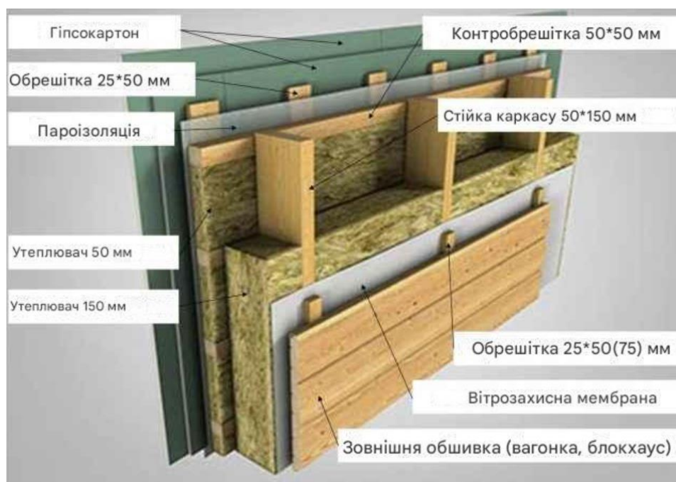
Рисунк 2.5 – Конструкція зовнішніх стін будинків
