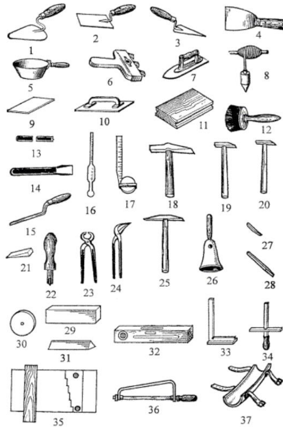
Рисунок 3.2 – Ручний інструмент плиточника: 1 – звичайний шпатель; 2 – квадратний шпатель; 3 – тример; 4 – сталевий шпатель; 5 – відро для штукатурки; 6 – кельма; 7 – гладилка; 8 – висок вагою 150 г; 9 – гумовий шпатель; 10 – шпатель; 11 – брусок; 12 – щітка; 13 – плоский брусок; 14 – скарпель; 15 – пазовий ущільнювач; 16 – манометр; 17 – рулетка (довжиною 2 м); 18 – молоток вагою 600 г; 19, 20 – молоток плитковий, вагою 80 г і 60 г; 21 – дубовий клин довжиною 5 см; 22 – сталеве зубило з наконечником з карбіду вольфраму; 23, 24 – плоскогубці; 29 – карборундовий брусок; 30 – карборундовий круг; 31 – трикутний брусок; 32 – рівень; 33 – сталевий кутник; 34 – шаблон; 35 – шаблон А.С. Афоніна; 36 – ножівка; 37 – коліно
