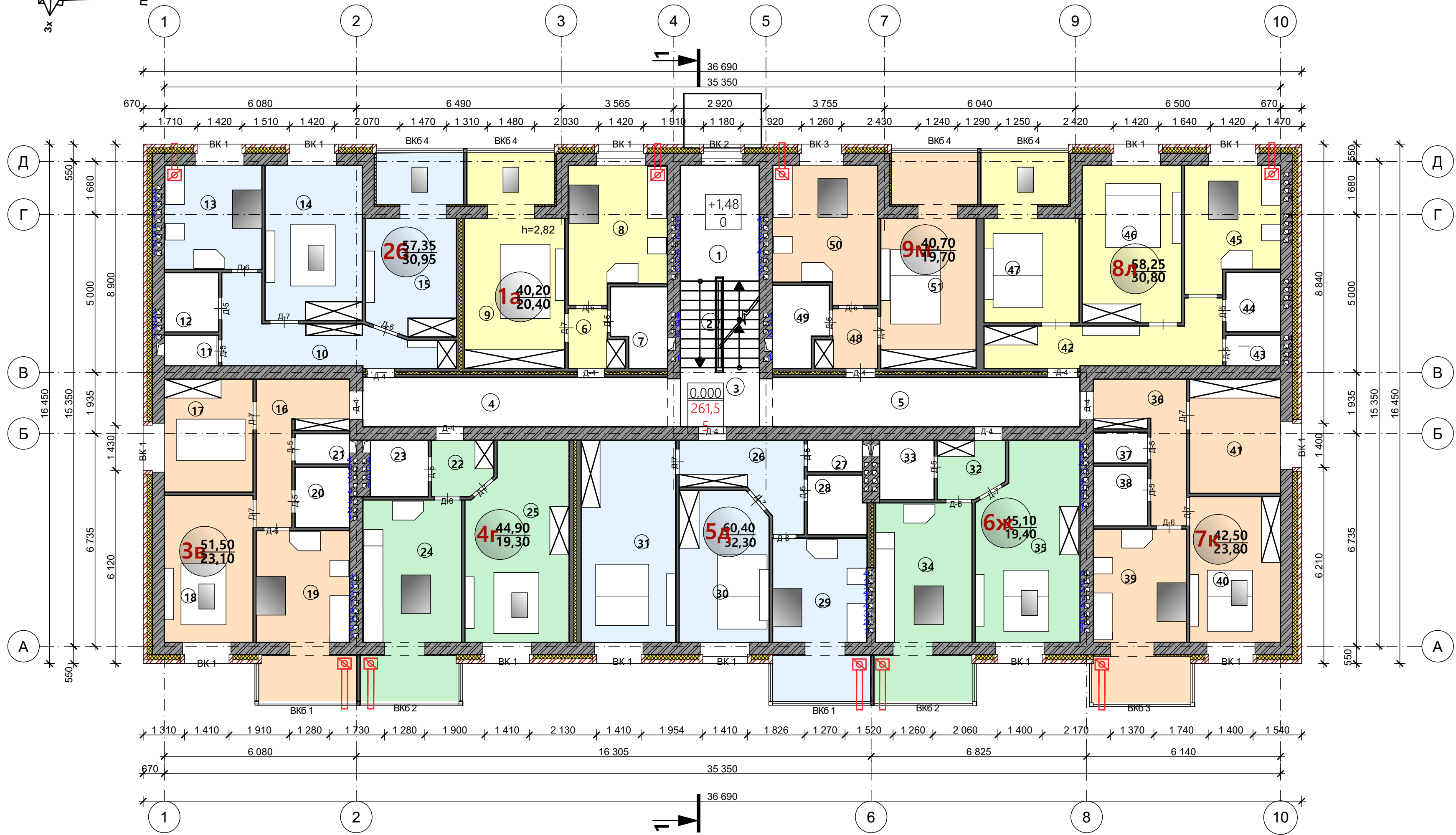
План перегородок 1-3-го поверху на відмітці 0,000/+3,000/+6,000 М 1:100
