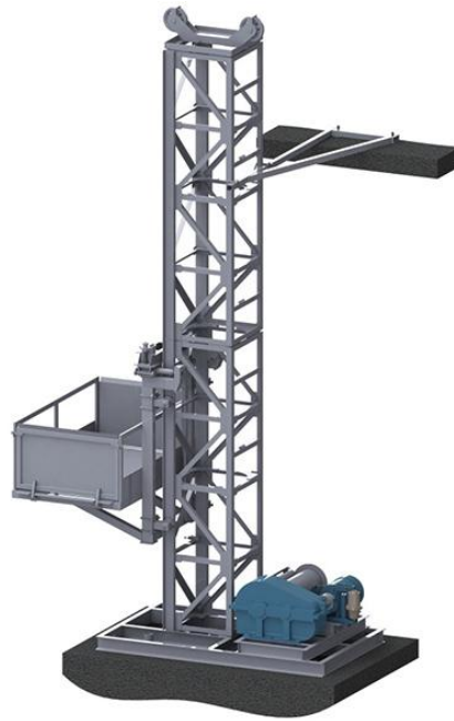
Рисунок 4.1 – Підйомник щогловий ТП-12
