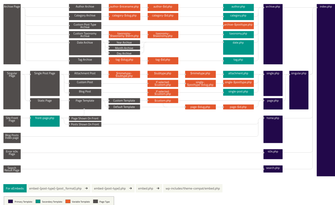
Рисунок 3.5 – Ієрархія шаблонів CMS WordPress
