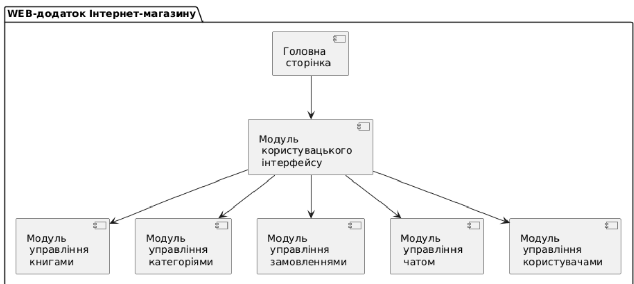
Рисунок 2.1 – Структурна схема WEB-додатку інтернет-магазину "Гай Монтег"
