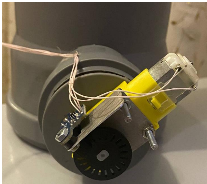
Рисунок 2.17 – Розміщення оптичного енкодера на прохідній осі двигуна
