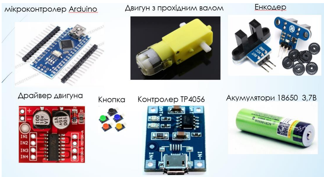
Рисунок Г.2 – Компоненти для реалізації електричної частини програмно-апаратного модуля автоматичної годівнички для тварин
