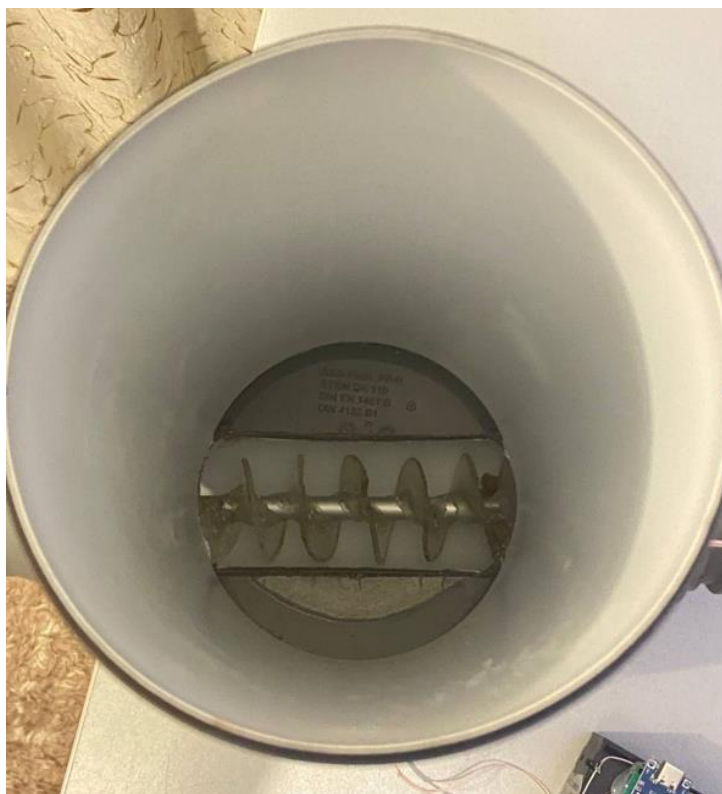
Рисунок 2.15 – Механізм подачі корму – вид зверху
