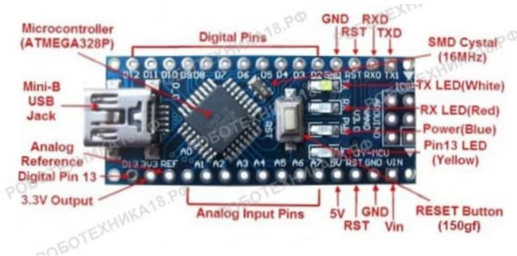
Рисунок 2.2 – Структура контролера Arduino Nano
