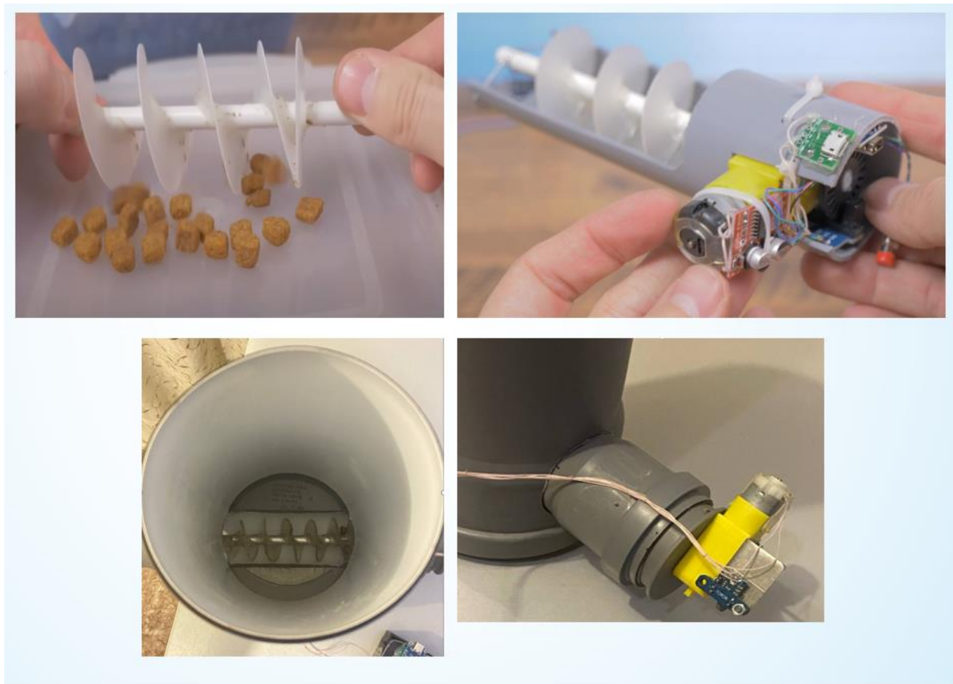
Рисунок Г.6 – Процес створення програмно-апаратного модуля автоматичної годівнички для тварин
