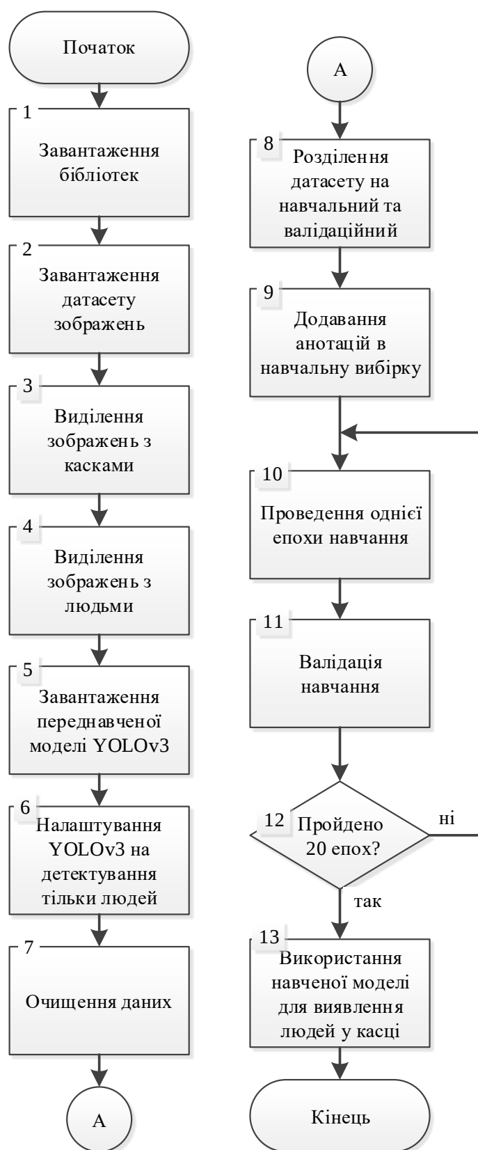
Рисунок В.1 – Схема алгоритму роботи програмного модуля розпізнавання людей у касці на основі згорткової нейронної мережі YOLOv3
