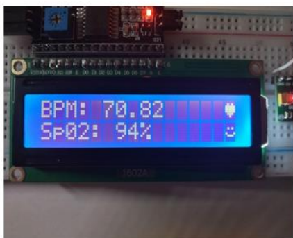
Рисунок Г.4 – Готовий пристрій для вимірювання серцебиття та сатурації
