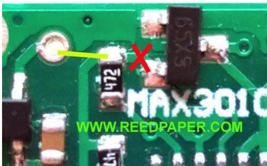
Рисунок 3.6 – Усунення дефекту в платі давача max30100
