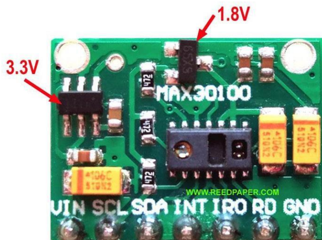
Рисунок 3.5 – Дефект подачі напруги давача max30100
