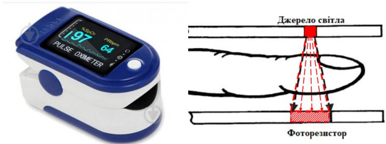
Рисунок Г.2 – Принцип роботи пульсоксиметра
