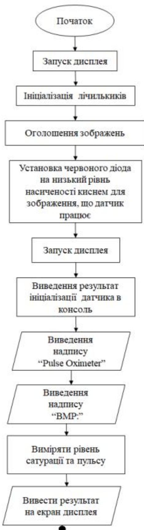
Рисунок 2.5 – Алгоритм роботи пристрою
