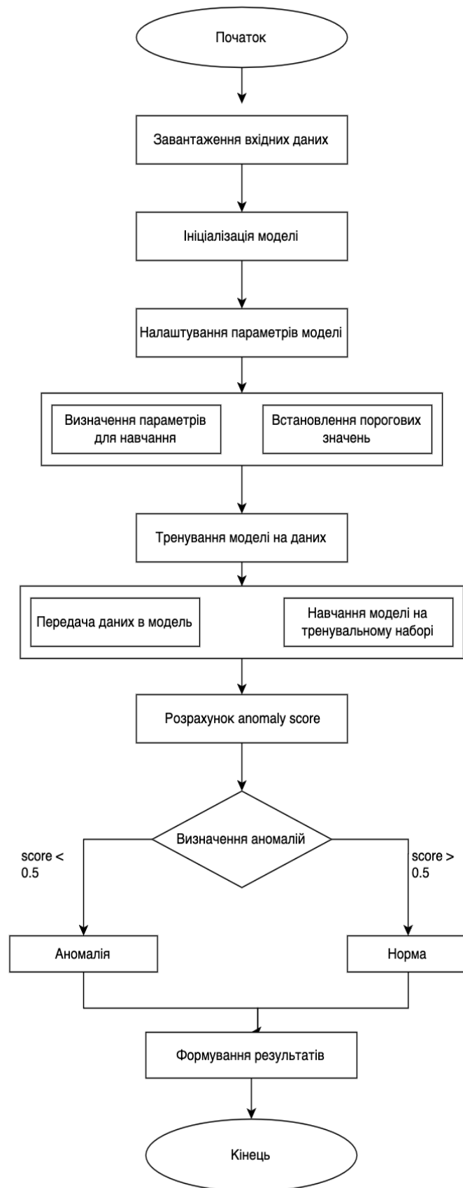
Рисунок Г.4 – Блок-схема модуля аналізу та виявлення аномалій
