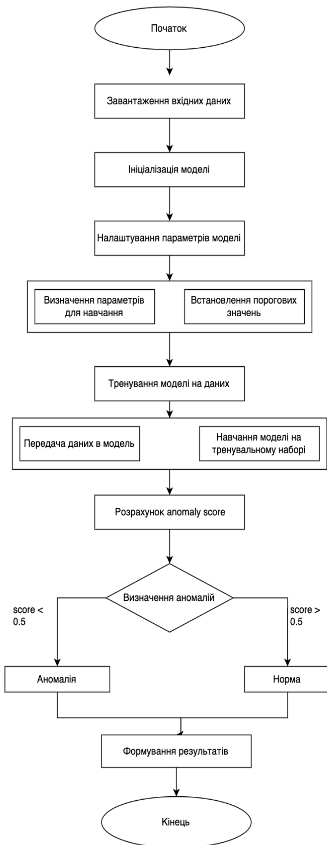
Рисунок 2.4 – Блок-схема модуля аналізу та виявлення аномалій
