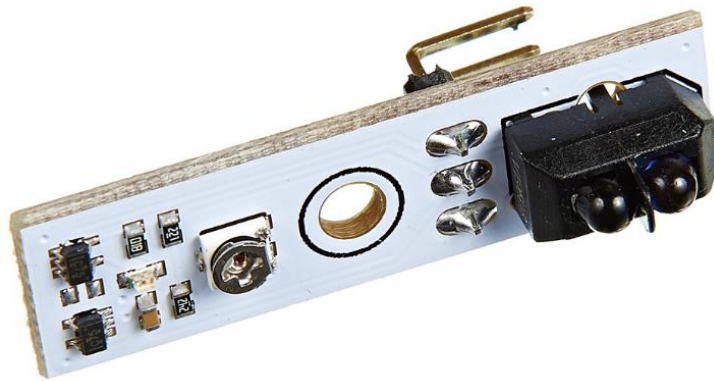
Рисунок 2.17 – Оптичний давач лінії KY-033
