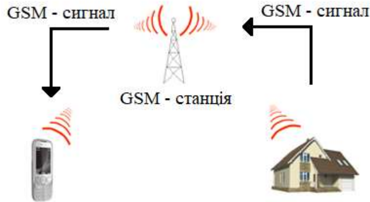
Рисунок 1.2 – Схема роботи GSM – сигналізації
