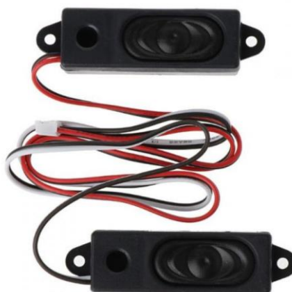
Рисунок 2.3 – Приклад динаміків 8 Ом / 2 Вт для генерації шуму
