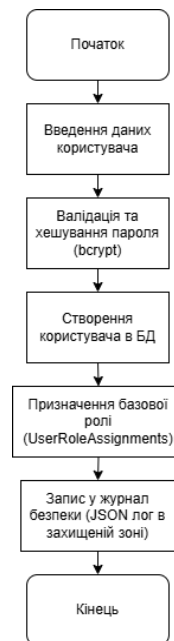
Рисунок 2.2 – Блок-схема алгоритму управління користувачами та ролями (створено автором)
