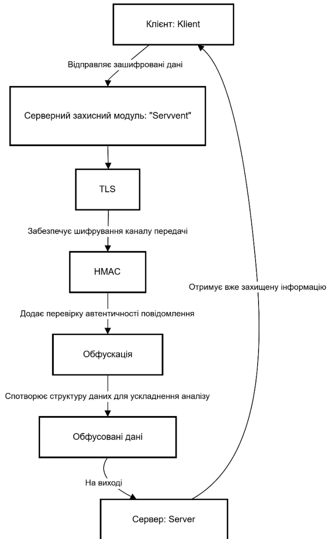
Рисунок 1.2 – Функціональна схема захисту WebSocket через TLS, HMAC і обфускацію
