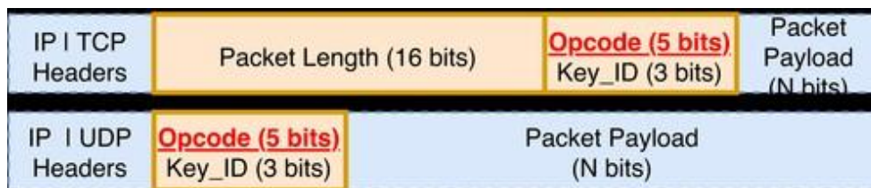
Рисунок 1.5 – Структура пакетів протоколу OpenVPN [5]
