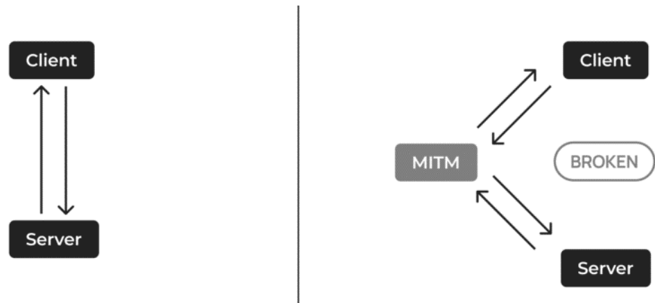
Рисунок 1.2 – Схематичне зображення атаки типу Man-in-the-Middle
