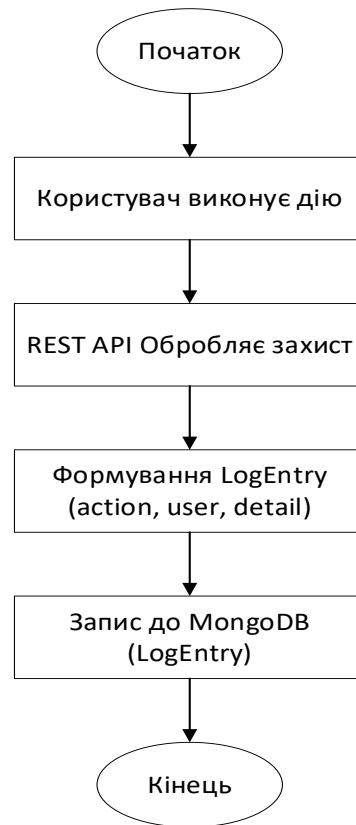
Рисунок 2.4 – Блок-схема логування подій у системі
