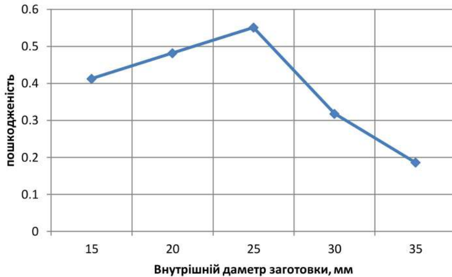
Рисунок 2.10 – Залежність пошкодженості матеріалу від внутрішнього діаметра заготовки
