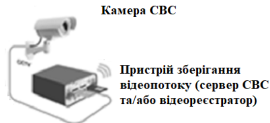
Рисунок 1.2 –Базова структура елементарної СВС на базі 1-ї відеокамери [3, 4]
