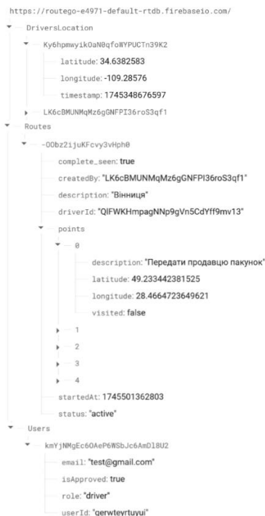
Рисунок 2.2 — Схема структури зберігання даних у хмарі
