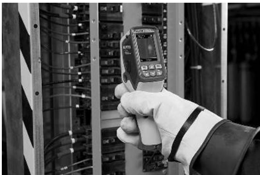
Рисунок 1.10 — Приклад тепловізійного обстеження промислового обладнання
